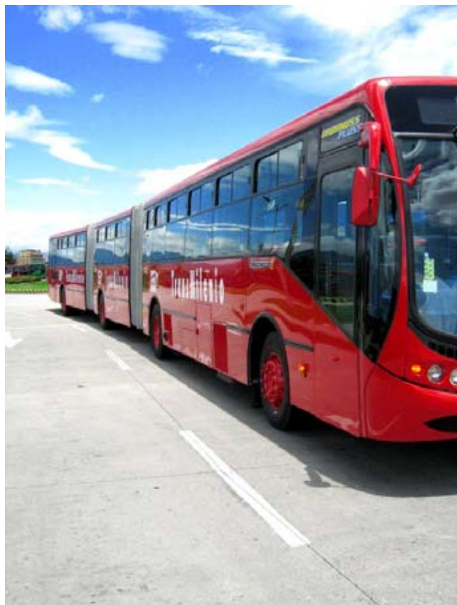
Figura 22. Los vehículos de un sistema bus rápido no deben ser necesariamente articulados e incluso muy pocas situaciones ameritan un vehículo biarticulado como el expuesto aquí (utilizado como prueba para TransMilenio). Cortesía TransMilenio SA
